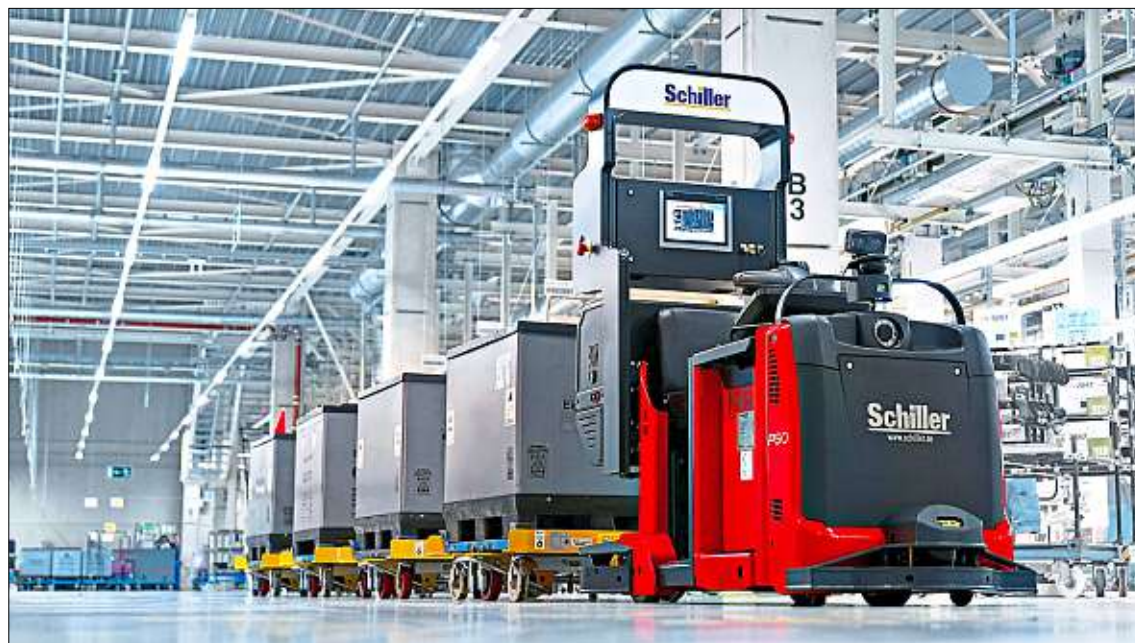
Der Routenzug in der Dingolfinger BMW-Endmontage: Nach der Umrüstung durch die Firma Schiller fährt der Elektroschlepper selbstständig zu den vorgegebenen Haltepunkten. – Fotos: Schiller
