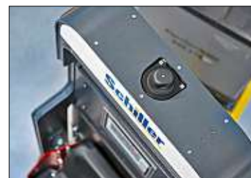
Mittels rotierendem Laser-scanner stellt der Zug fest, wo er sich in der Halle befindet.
