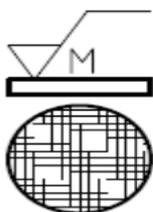
Die Rillenrichtung muß nach der Fertigung viele verschiedene Richtungen aufweisen.
